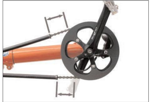
Zwischen den Enden der Kettenschutzrohre und den Schaltungsteilen müssen bei gespannter Kette mindestens 5 cm Abstand verbleiben.
