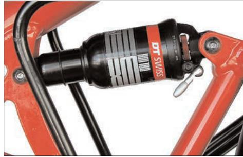
*Federelement DT-Swiss XMI 180. Die Einstellung der Dämpfung erfolgt über das rote Rad am hinteren Ende. Das Federelement muss so eingebaut sein, dass der Kipphebel zur Blockierung am hinteren Ende nach unten zeigt, damit der Hebel beim Einfedern nicht an den Rahmen anschlägt.*
