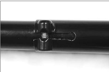
Beim Blick in den Klemmschlitz darf das Rohrende der oberen Vorbauhälfte nicht sichtbar sein.
