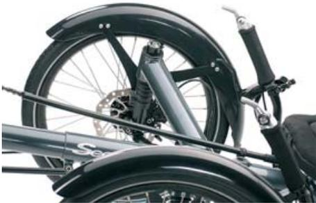
Optimierter Schutz mit eleganter Linienführung: HP VELOTECHNIK hat mit den Trikefedern Schutzbleche speziell für den Einsatz an Dreirädern entwickelt. Die Innenseite und die Unterseite sind weit heruntergezogen, um den Spritzschutz zum Fahrer insbesondere beim Kurvenfahren zu verbessern. Die Halteelemente sind geschützt auf der Innenseite angebracht. Das gerundete Profil mit 60 mm Breite ermöglicht die Montage von großvolumigen, komfortablen Reifen wie dem SCHWALBE Big Apple bis 50 mm Breite.
