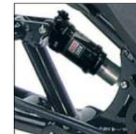
**Luftfederlement *Monarch RL*** von ROCK SHOX. Praktisch: Einfach per Pumpe kann die Federhärte an die Zuladung angepasst werden. Mit einer einstellbaren hydraulischen Zugstufendämpfung und blockierbarer Druckstufe ausgestattet, überzeugt es mit hervorragendem Ansprecherhalten in unseren Tests. 262 g Gewichtssparnis gegenüber dem Stahlfederlement DNM-22.
