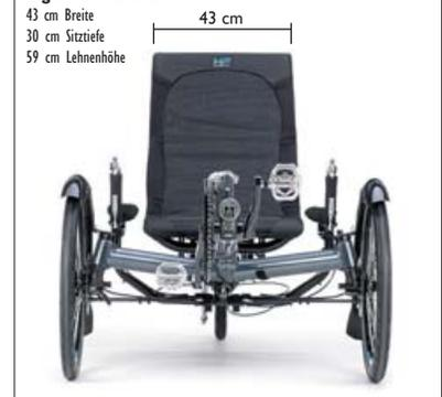
**Verändern Sie öfter Ihr Niveau!** Die orthopädisch überzeugenden Sitzsysteme von HP VELOTECHNIK sind per Schnellspannbefestigung in 15 Sekunden abnehmbar und damit im Handumdrehen untereinander austauschbar.
