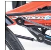
**Rahmenschnellverstellung:** Zwei Schnellspanner, und schon lässt sich Ihr *Scorpion* im Handumdrehen auf unterschiedliche Beinlängen einstellen. Die von HP VELOTECHNIK für Messe- und Vorführäder entwickelte *Rahmenschnellverstellung* hat für Sie den Vorteil, dass Sie das Rad zu Transportzwecken in Sekundenschnelle kleiner machen können: einfach Ausleger einschieben.
