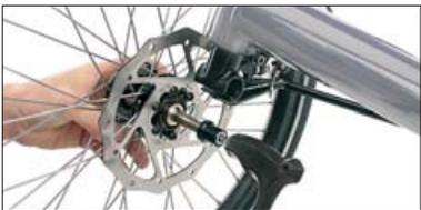
Praktisch beim Transport: HP VELOTECHNIK hat offene Radträger entwickelt, mit denen die Vorderräder mitsamt den Bremscheiben nach dem Lösen nur einer Schraube einfach abgenommen werden können. (Serienausstattung)
