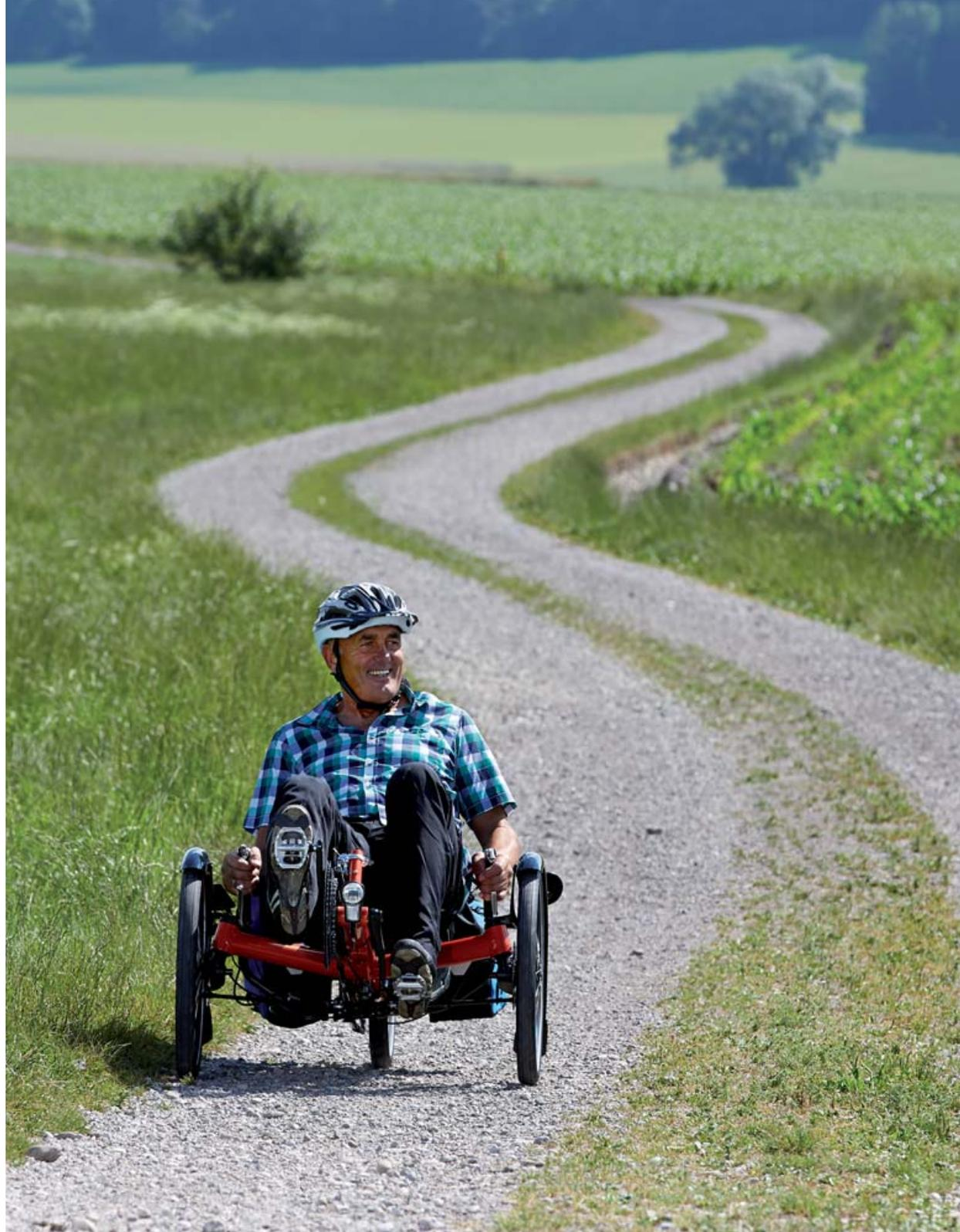
Breiter ist besser: Je breiter die Spurweite, desto höher ist die Kippstabilität und desto schneller kann Ihr Trike in Kurven gefahren werden. Ausserdem erlaubt eine breite Spurweite mehr Lenkeinschlag für einen kleinen Wendekreis. Damit Ihr Trike dennoch lässig durch Türen und Gatter schlüpf, hat HP VELOTECHNIK schmale Naben für eine geringe Gesamtbreite von nur 83 cm entwickelt.
