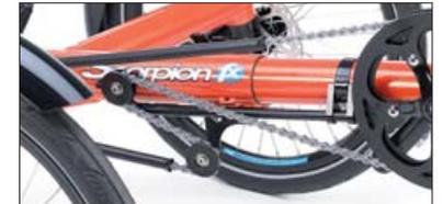
Mit der optionalen Rahmenschnellverstellung kann das Rad rasch auf unterschiedliche Beinlängen eingestellt werden. Durch Einschieben des Tretlagerauslegers wird Ihr *Scorpion fx* beim Transport damit noch kompakter.
