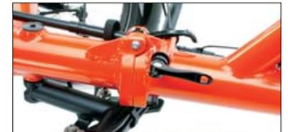
Das robuste patentierte Faltgelenk von HP VELOTECHNIK rastet beim Auseinanderfallen selbsttätig ein. Der Sicherungshebel wird komfortabel von oben bedient. Spielfreie Edelstahl-Achse für dauerhaft präzises Falten.
