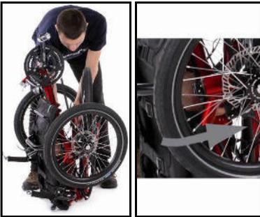
2. Mit der rechten Hand das Hauptrahmenrohr bzw. den Ausleger direkt über der Sitzlehne umgreifen (Knöchel zeigen vom Rad weg).
