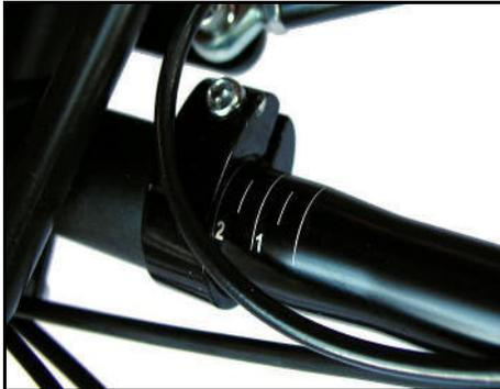
Die Verstellung von Lenkerneigung und -breite erfolgt über die Klemmschellen am Lenkervorbau unter dem Rahmen.
