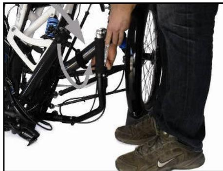
Sichern des Rahmens gegen Auseinanderfalten am Querrohr mittels Klettverschluss
