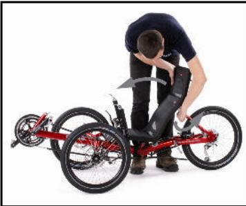
2. Zur Sicherung der Rückenlehne Klettgurt vom zweiten Spannriemen abziehen und auf den Klettbandflausch unter dem Rahmenquerrohr aufkletten.
