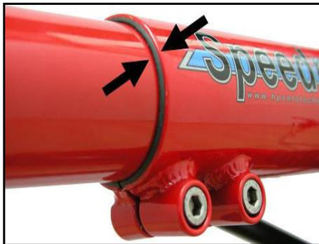
Zwischen dem Hauptrahmen und dem Tretlagerausleger muss die Distanzbuchse sichtbar sein.
