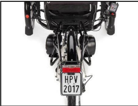
*Hintere Lichtenanlage mit Bremslicht am Gepäckträger des S-Pedelec.*
