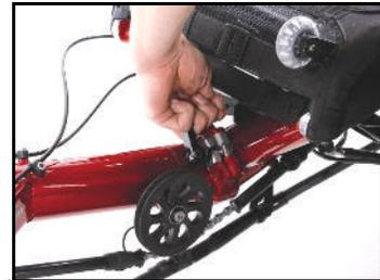
5. Den Klettgurt der Rückenlehne unter dem Querträger lösen und am Sitz befestigen.
