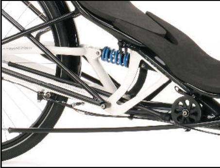
*Kettenleitrolle, Kettenfangwinkel und Kettenschutzrohre am Scorpion fs 26.*
