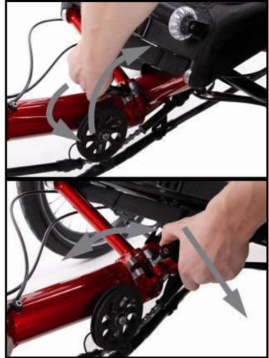
4. Das Hauptrahmenrohr bzw. den Ausleger vor der Oberkante der Rückenlehne mit der rechten Hand umfassen (Knöchel zeigen in Fahrtrichtung rechts) und leicht niederdrücken, damit das Faltgelenk nicht wieder einrastet. Die linke Hand umgreift die linke Sitzstrebe von oben, die Knöchel zeigen nach hinten.
