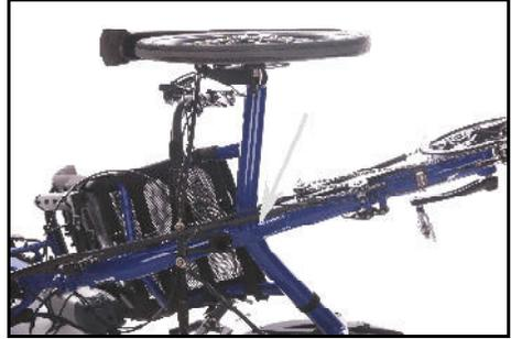
Position der Radcodierung an Gekko fx 20
