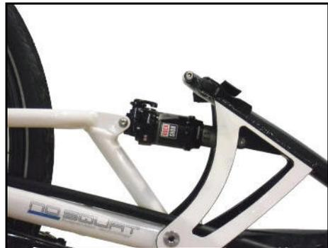
*Die Einstellung der Dämpfung erfolgt über das Rad am hinteren Ende. Das Luftfeder-element wird je nach Mo-dell so eingebaut, dass der Kipphebel zur Blockierung am hinteren Ende nach oben (Scorpion I fs 26 I fs 26 Enduro I fs 26 S-Pedelec I plus 20 I plus 26) bzw. nach unten (Scorpion fx I fs 20) zeigt.*
