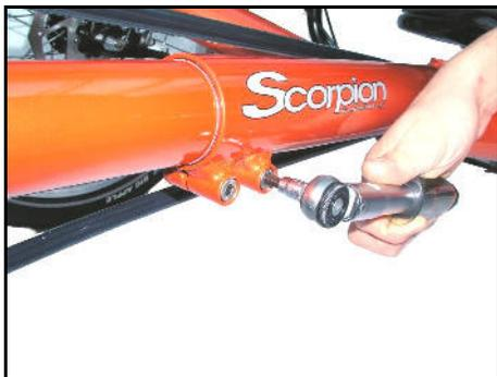
Lösen der Klemmschrauben zum Verstellen des Tretlagerauslegers.
