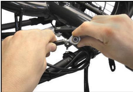
Richten Sie beide Kugelhöpfe parallel aus. Halten Sie den Gelenkkopf mit Gabelschlüssel oder Zange und ziehen Sie die Kontermutter mit 4 – 5 Nm gegen die Spurstange fest.
