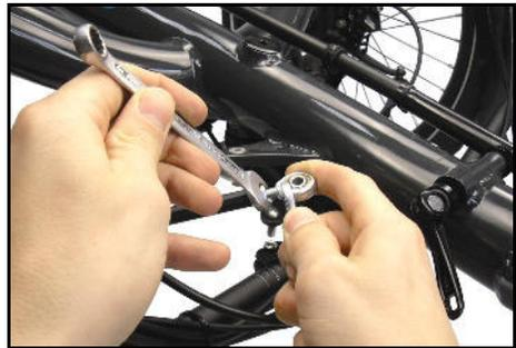
Drehen Sie den Gelenkkopf in die Spurstange hinein, um den vorderen Abstand  $b_v$  zwischen den Vorderrädern zu vergrößern, drehen Sie
