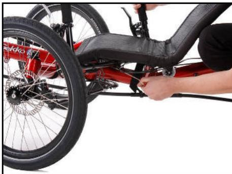
Die Verstellung der Klemmschrauben erfolgt über die Klemmung am Lenkervorbau unter dem Sitz
