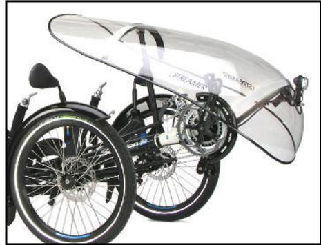
Wetterschutzverkleidung „Streamer“ am S-Pedelec
