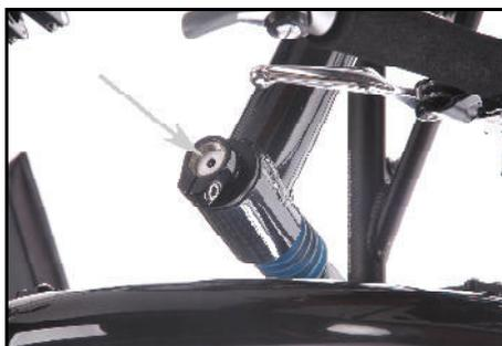
*Einstellschraube für die Federvorspannung des Federlements im inneren des Radträgers*
