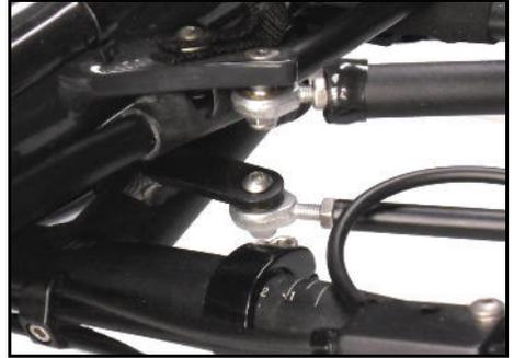
Befestigen Sie den Gelenkkopf am Lenkervorbau. Schieben Sie dazu zuerst die Unterlegscheibe und danach den Gelenkkopf von unten auf die Schraube, die in der Bohrung des Halblechs am Lenkervorbau steckt. Befestigen Sie den Gelenkkopf mit der selbstsichernden Mutter. Messen Sie die Spur wie oben beschrieben. Wiederholen Sie die Einstellarbeit, bis der korrekte Spureinstellwert erreicht ist.
