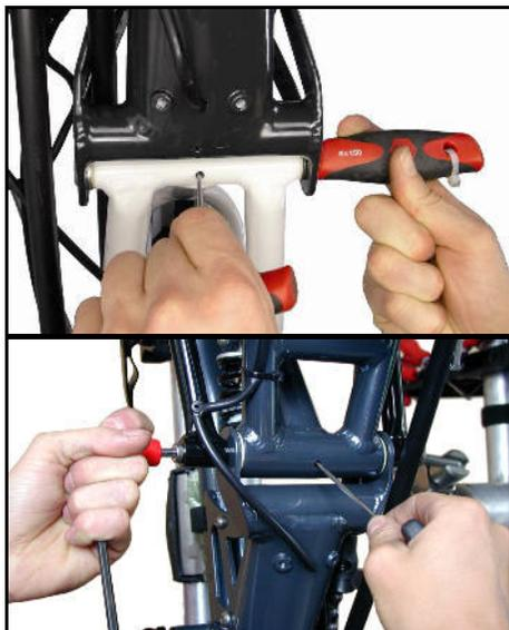
Auf der Unterseite der Hinterradschwinge befindet sich eine Bohrung. Mit einem dünnen Schraubendreher oder einem Metallstift kann die Achse gegen Verdrehen gesichert werden. Oben: Scorpion fs 26; Unten: Scorpion fx
