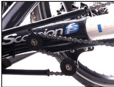
*Verlauf der Kette über die Umlenkrollen bei Rahmenschnellverstellung.*
