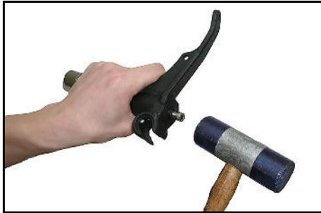
Durch Hammerschläge auf die Schraube wird die Kolbenstange im Radträger aus ihrer Aufnahme gelöst.
