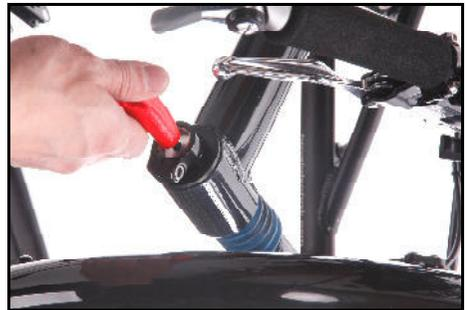
Lösen Sie die Klemmschelle, um die Einstellschraube des Federbeins drehen zu können.
