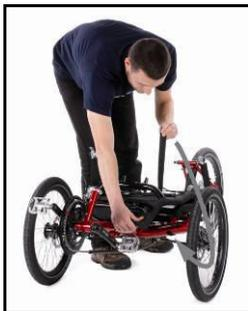
3. Schnellspannhebel am Faltgelenk in der Rahmenmitte öffnen, den Sicherungsbolzen gegen Federdruck entriegeln und Faltgelenk etwas nach oben öffnen. Den Schnellspannhebel soweit nach oben schwenken, bis er in senkrechter Position einrastet.
