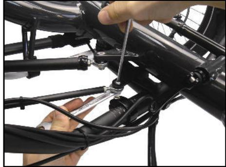
Halten Sie den Gelenkkopf mit einem Gabelschlüssel oder einer Zange am Gehäuse und lösen Sie die Kontermutter, die gegen die Spurstange geschraubt ist.
