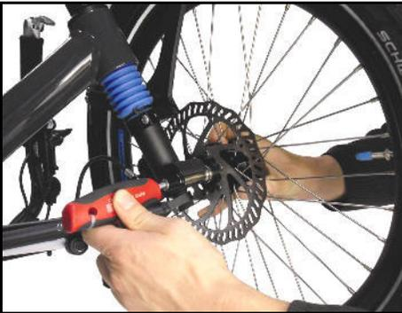
Vorderradausbau: Lösen der Schraube im Endstück
