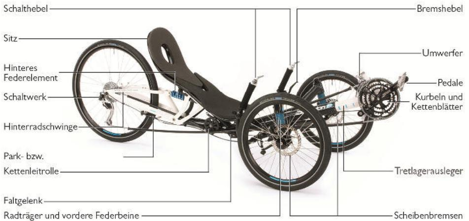
Die Abbildungen zeigen das Scorpion fs 26 S-Pedelec (oben) und das Scorpion fs 26 (unten). Die gekennzeichneten Komponenten sind an den anderen Rädern vergleichbar.
