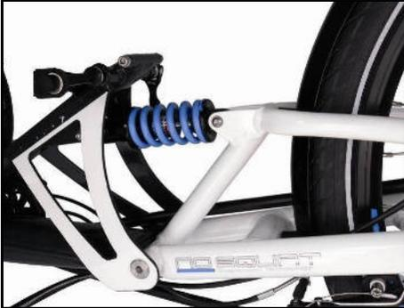
Federelement mit Stahlfeder. Durch Drehen des Einstellringes am vorderen Ende der Stahlfeder stellen Sie die Federvorspannung ein
