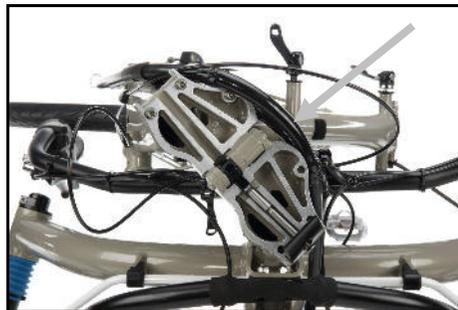
Die Kettenschutzrohre müssen zum Falten seitlich am Falgelenk vorbeigeführt werden.
