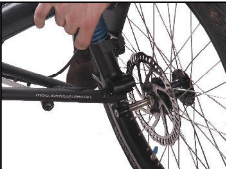
Vorderradausbau: Achse aus dem Radträger lösen
