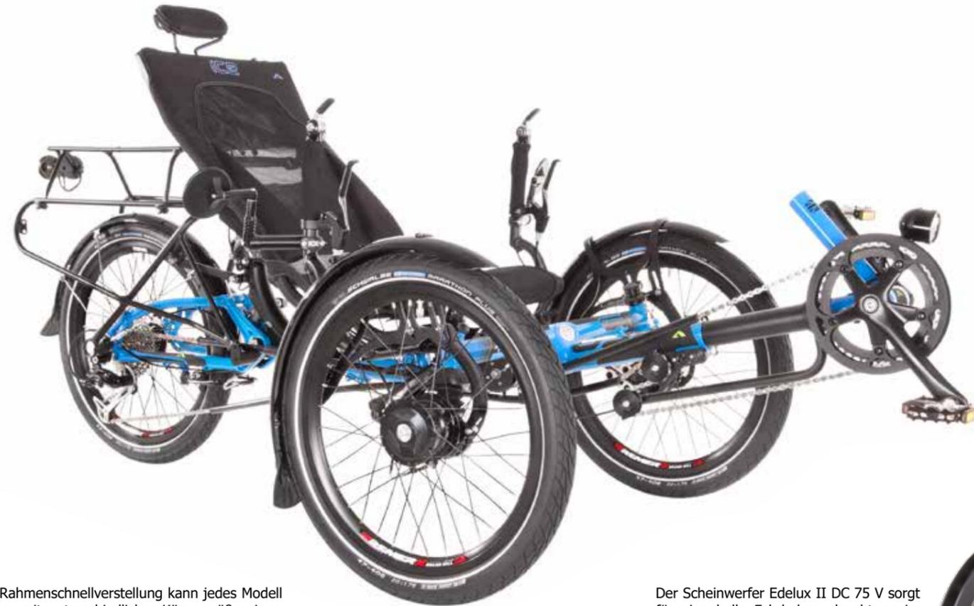
Mit der Rahmenschnellverstellung kann jedes Modell für Fahrer mit unterschiedlicher Körpergröße eingestellt werden, ohne dass dabei die Kette verlängert oder gekürzt werden muss. So können sich mehrere Personen mit unterschiedlicher Körpergröße ohne großen Umbauaufwand ein Trike teilen.
