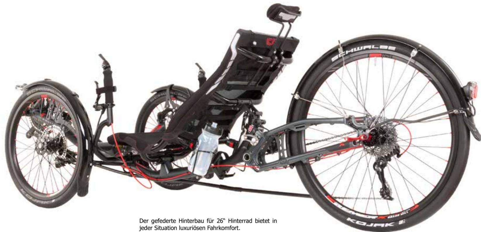
Der gefederte Hinterbau für 26" Hinterrad bietet in jeder Situation luxuriösen Fahrkomfort.
