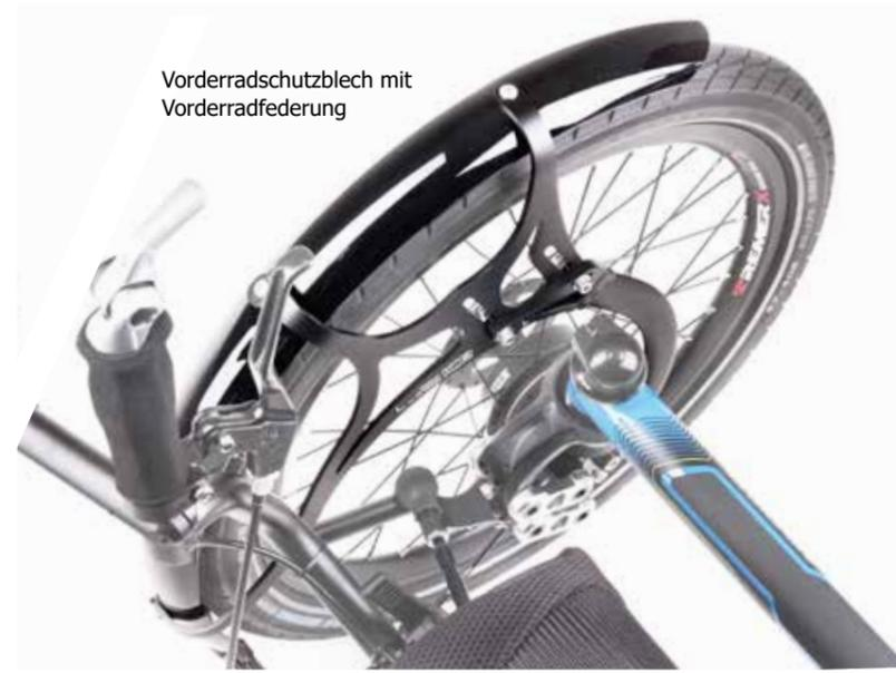
Vorderradschutzblech mit Vorderradfederung
