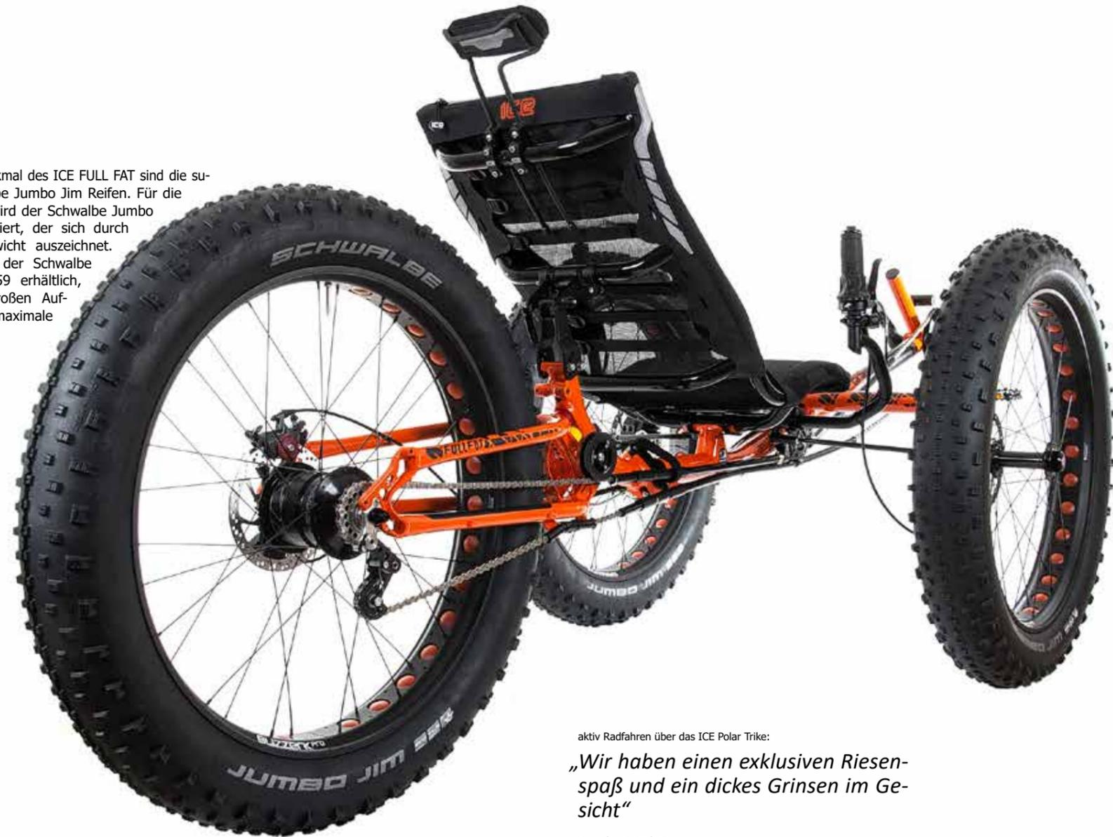
Das besondere Merkmal des ICE FULL FAT sind die super breiten Schwalbe Jumbo Jim Reifen. Für die Basisausstattung wird der Schwalbe Jumbo Jim 100-559 montiert, der sich durch sein geringes Gewicht auszeichnet. Optional ist auch der Schwalbe Jumbo Jim 120-559 erhältlich, der mit seiner großen Aufstandsfläche für maximale Traktion sorgt.
